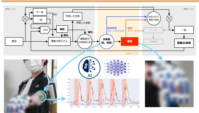
表面筋電図信号を入力値と、人工知能を用いた解析アルゴリズムを使用して対象者の運動意図を読み取り判定し、その結果に基づきロボットが駆動します。
